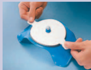
1. Τοποθετούμε την ετικέτα στο ειδικό μηχανήμα εφαρμόζοντας τα αυτιά στις εγχοπές.
